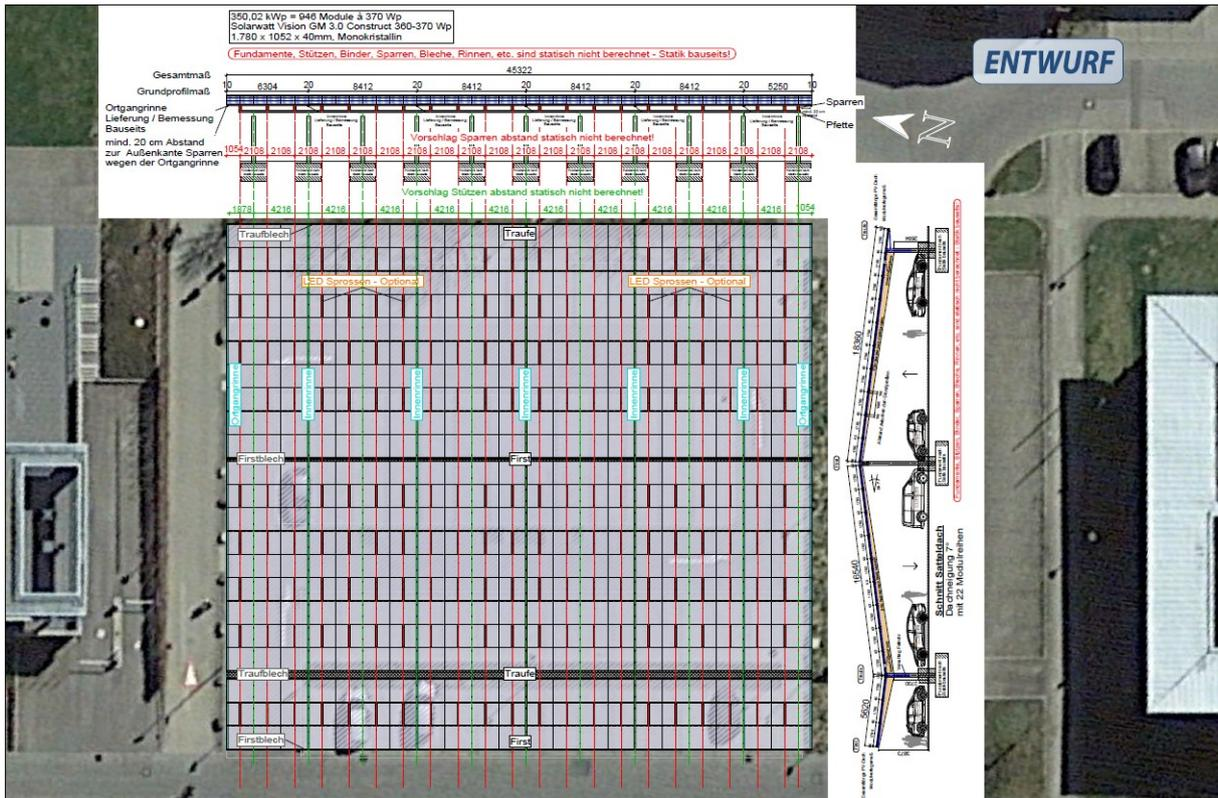
Abbildung 2: Schnitt und Belegungsplan nach einem ersten Entwurf der Firma ClickCon
