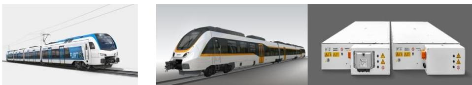
Abbildung 4 Vierteiliger Stadler FLIRT 3 (links) und Bombardier Talent 3 mit Akkus (Modellabbildung, bisher in Deutschland nicht im Einsatz)
